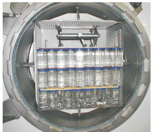
Spannvorrichtung mit 3 Lagen Gläsern Clamping device with 3 layers of glass jars
