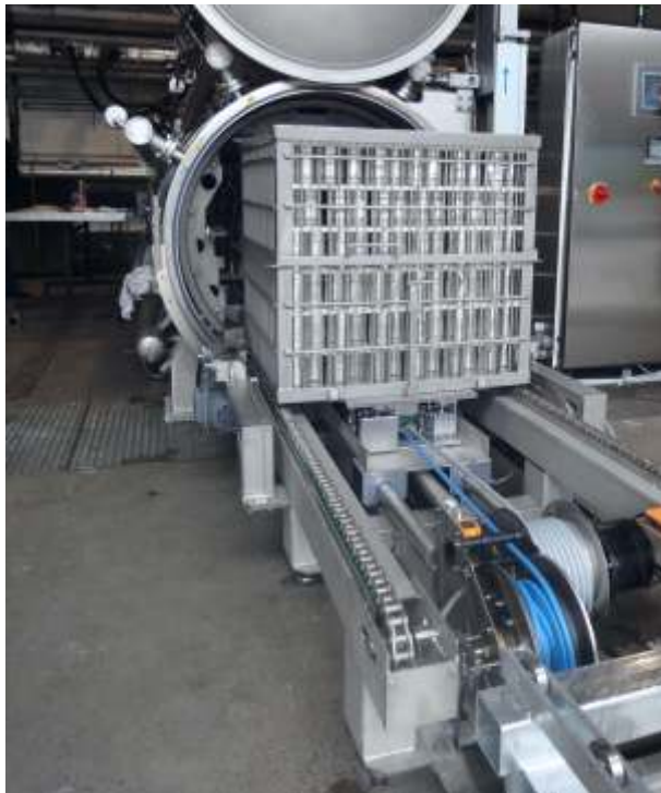
Shuttlesystem für komfortable Beladung Shuttle system for comfortable loading
